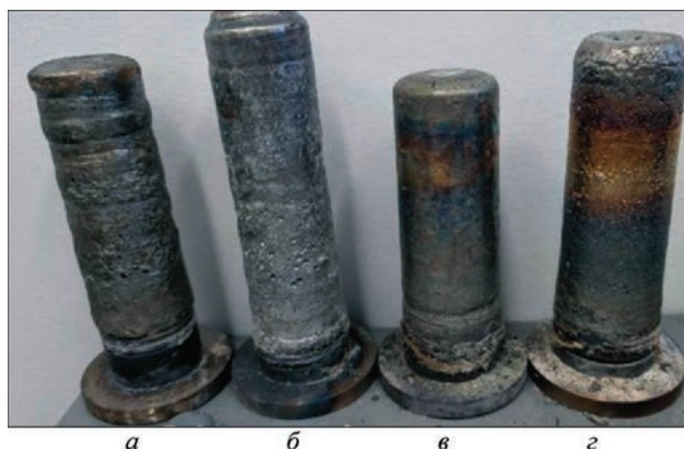
Рис. 1. Зливки, отримані в результаті плавок під різними флюсами: а — АНФ-1; б — АНФ-7; в — АНФ-28; г — 3/3/3
