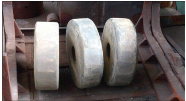
Рис. 4. Ковані диски діаметром 440×145 мм титанового сплаву BT8
