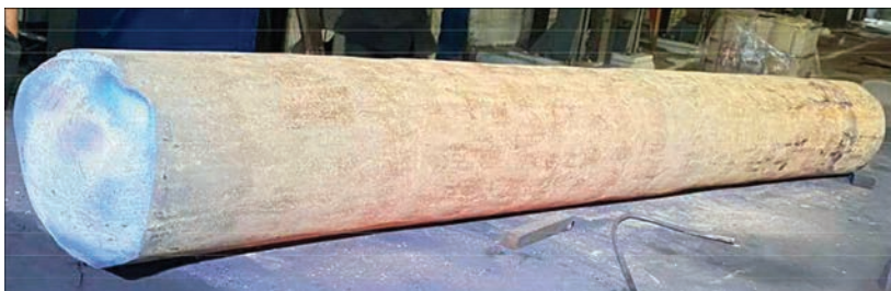
Рис. 3. Кований пруток діаметром 200 мм із титанового сплаву BT8
