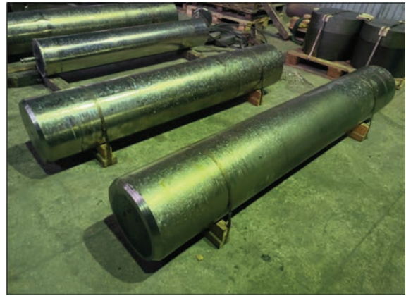
Рис. 1. Партія зливок діаметром 400 мм титанового сплаву ВТ8, отриманих способом ЕПП
