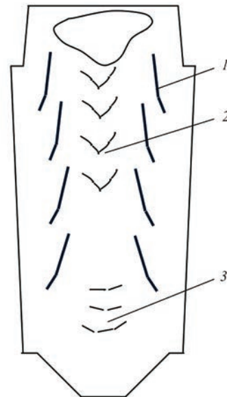
Рис. 1. Схема розташування в сталевому зливку локальної хімічної неоднорідності: 1 — позацентрова (А-подібна); 2 — осьова (V-подібна); 3 — негативна ліквація
