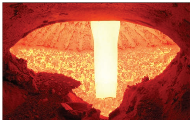
Рис. 5. Загальний вигляд нижньої частини гнотового електрода з вихідним діаметром 350 мм
