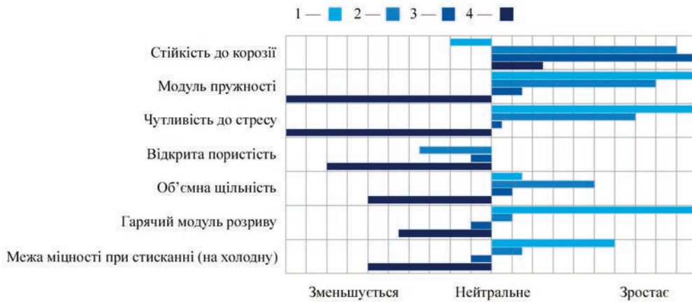
Рис. 1. Діаграма залежності властивостей MgO–C цегли від модифікацій: 1 — антиоксиданти; 2 — плавлена магnezія; 3 — сорт MgO; 4 — вуглець
