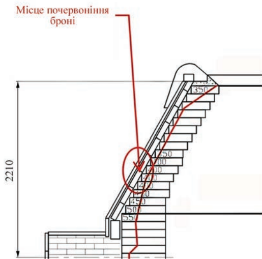
Рис. 3. Зона локального зносу в верхньому конусі конвертера лення конструкції футерування стало можливим збільшити кампанію конвертера і раціоналізувати витрати на вогнетривку футерування.
