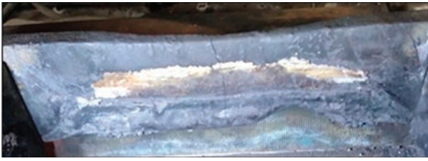
Рис. 2. Поверхня мідної стінки струмопровідної секції СПК з поперечним перерізом 250×250 мм у зоні накатки після експлуатації протягом 15 год
