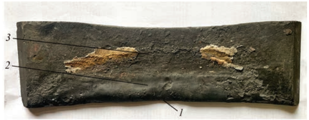
Рис. 3. Робоча пластина графітового футерування струмопровідної секції СПК поперечного перерізу 250×250 мм, вилучена з секції після її експлуатації, з утворенням на її поверхні зон зношування: 1 — торцева; 2 — футерована; 3 — окислена
