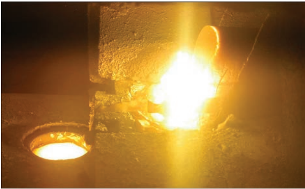
Рис. 3. Процес плавки зливка діаметром 110 мм сплаву ортоалюмініду титану Ti-39Nb-16Al-2,6Mo-1,4Zr
