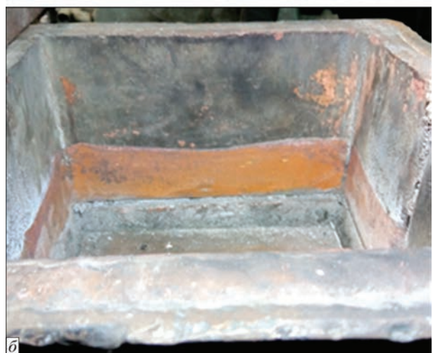
Рис. 1. Струмопровідний кристалізатор поперечного перерізу 200×200 мм до початку експлуатації (а) і робоча поверхня його струмопровідної секції після 10 год експлуатації (б)
