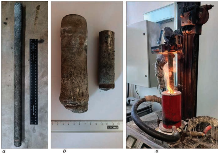
Рис. 1. Зовнішній вигляд витратного електрода (а), одержаного злитка і залишку електрода (б) та лабораторної електрошлакової печі під час проведення переплаву (в)
