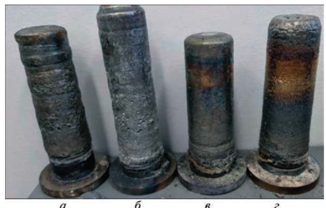
Рис. 1. Зливки, отримані в результаті плавок під різними флюсами: а — АНФ-1; б — АНФ-7; в — АНФ-28; з — 3/3/3
