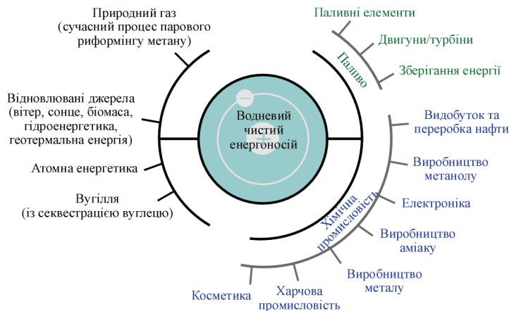
Рис. 4. Бачення H 2 @Scale отримання водню, у тому числі з відновлюваних джерел, та його використання
