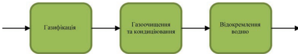
Рис. 5. Загальна технологічна схема виробництва водню шляхом плазмової газифікації
