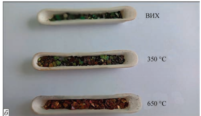
Рис. 2. Схема відбору зразків КМ Fe–NaCl на підкладці, що обертається, (а) і зразки МШКМ NaCl–14 мас. % Fe вагою по 2 г в корундових тиглях після відпалу (б)
