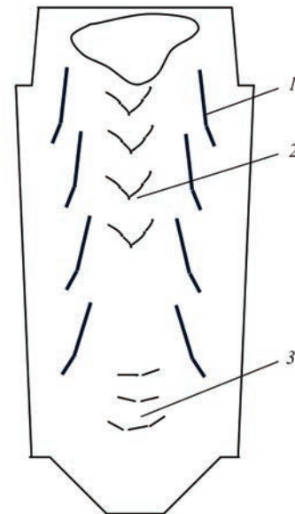
Рис. 1. Схема розташування в сталевому зливку локальної хімічної неоднорідності: 1 — позакцентрова (А-подібна); 2 — осьова (V-подібна); 3 — негативна ліквація
