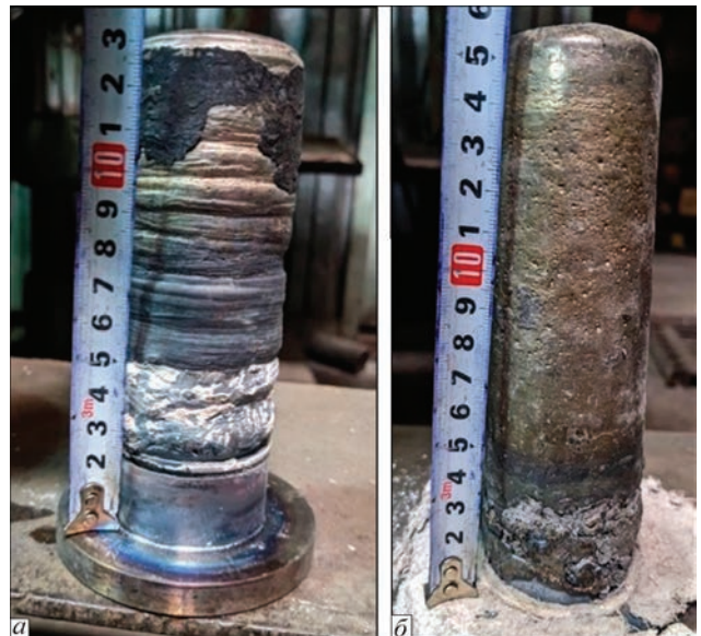
Рис. 2. Зовнішній вигляд злитків ЕШП, отриманих під флюсом з CaF_2 (а) та флюсом 33 % CaF_2 — 33 % CaO — 33 % Al_2O_3 (б)
