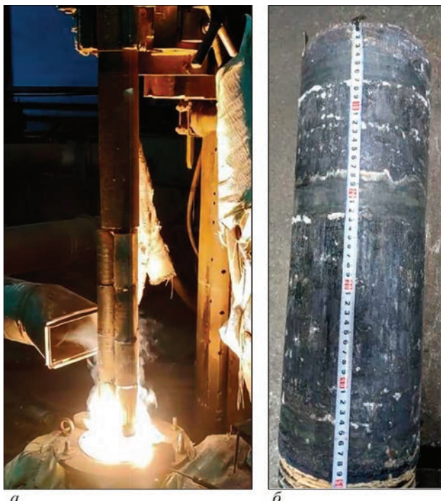
Рис. 3. Процес електрошлакового переплаву витратного електрода (а) та зовнішній вигляд отриманого зливка (б)
