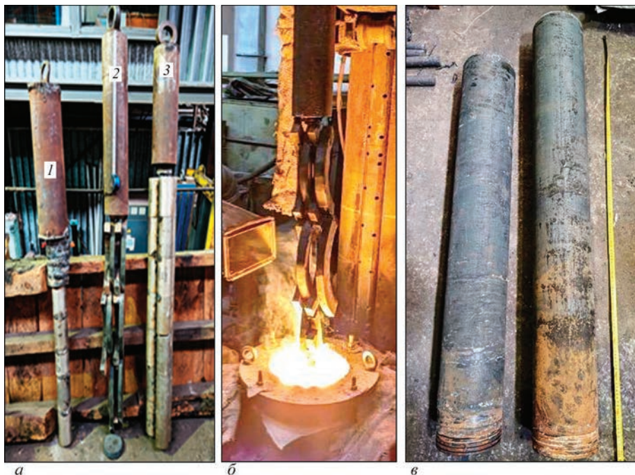
Рис. 5. Загальний вигляд електродів, підготовлених до плавки 2 (а); процес електрошлакового переплаву електрода, сформованого із залишків кілець (б); зливки, отримані після переплаву дослідних електродів, довжиною 1100 мм (плавка 2) та 1250 мм (плавка 3) (в)
