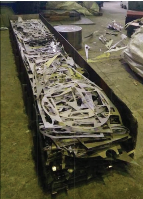
Рис. 9. Шихтова заготовка для виплавки зливка-слябу сплаву Ti-6Al-4V
