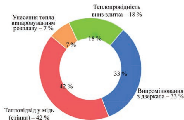
Рис. 4. Інтегральний баланс витрат тепла у прямокутному кристалізаторі
