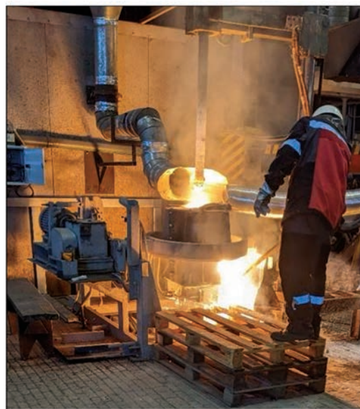
Рис. 2. Загальна схема електрошлакової плавильної установки (а) та її вигляд під час плавки (б)
