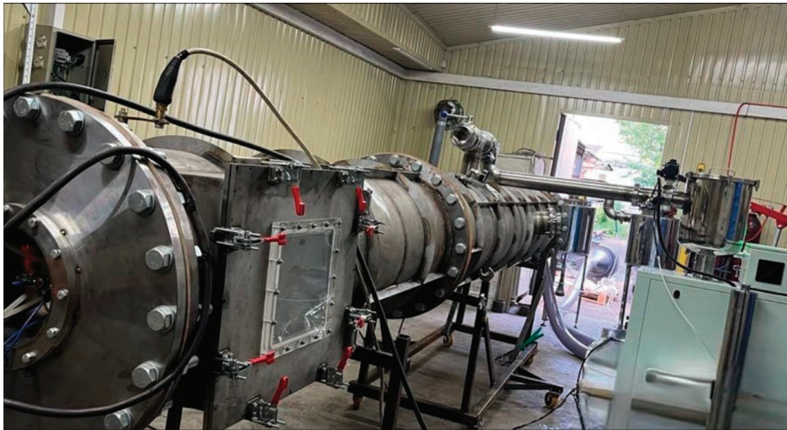
Рис. 8. Горизонтальна камера плазмово-дугового розпилення порошкових матеріалів
