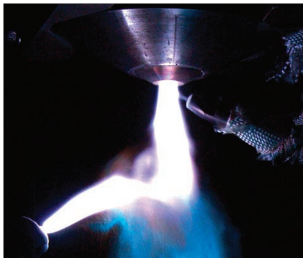
Рис. 6. Зовнішній вигляд процесу плазмової сфероїдизації на повітрі
