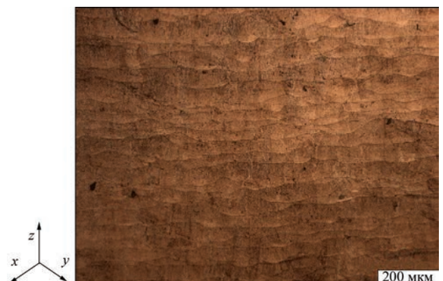
Рис. 3. Мікроструктура сплаву Ti-6Al-4V у площині x - y
