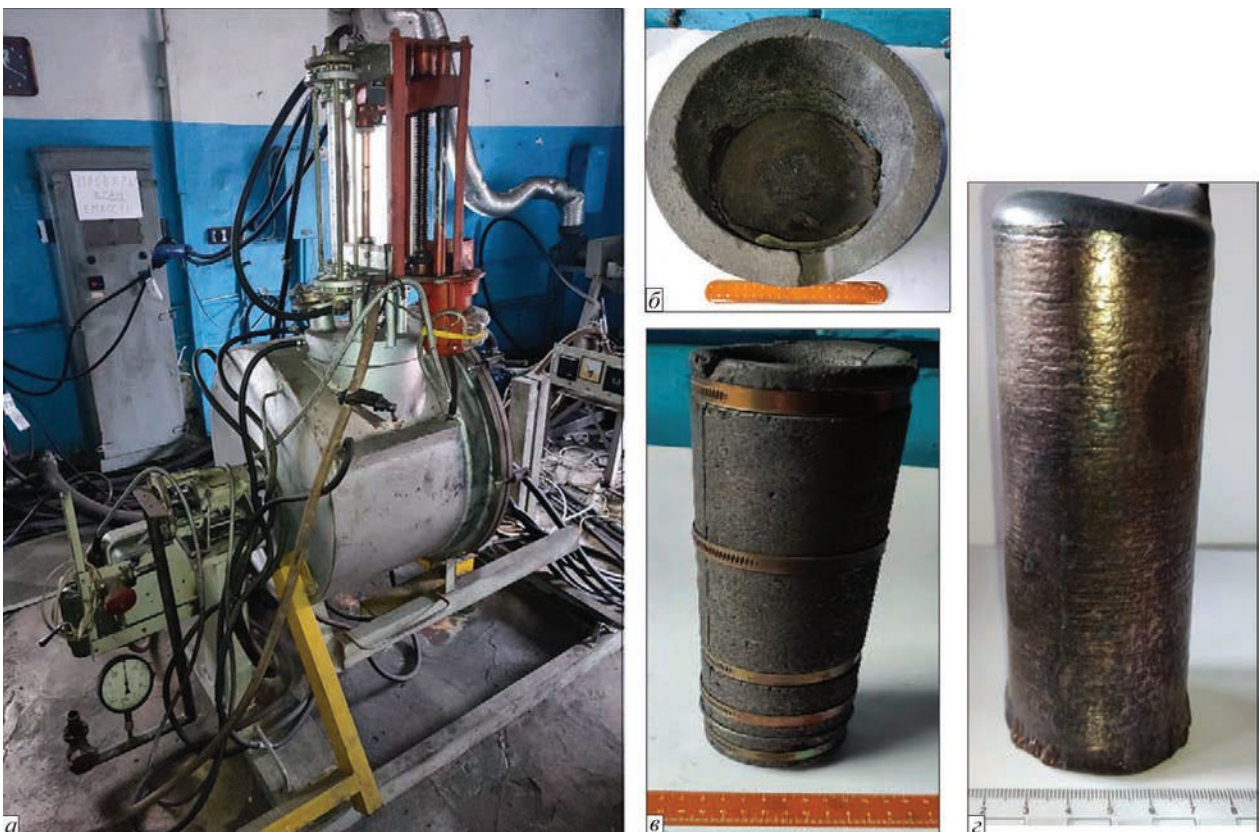
Рис. 1. Обладнання для отримання зливка: вакуумно-дугова піч (а), тигель (б), кокіль (в); зовнішній вигляд отриманого зливка (г)
