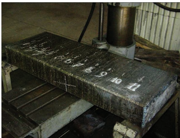
Рис. 11. Зливко-сляб перерізом 170×600 мм сплаву титану Ti-6Al-4V
