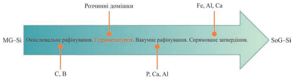
Рис. 1. Схема виробництва кремнію сонячної якості методом металургійного рафінування [15]
