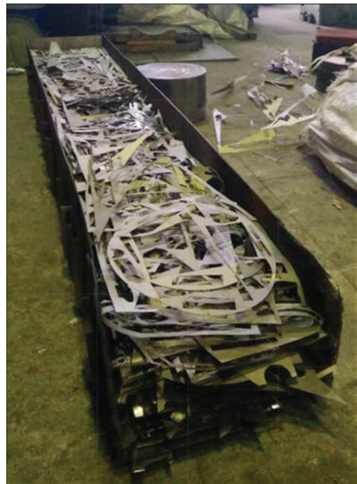
Рис. 9. Шихтова заготовка для виплавки зливка-слябу сплаву Ti-6Al-4V
