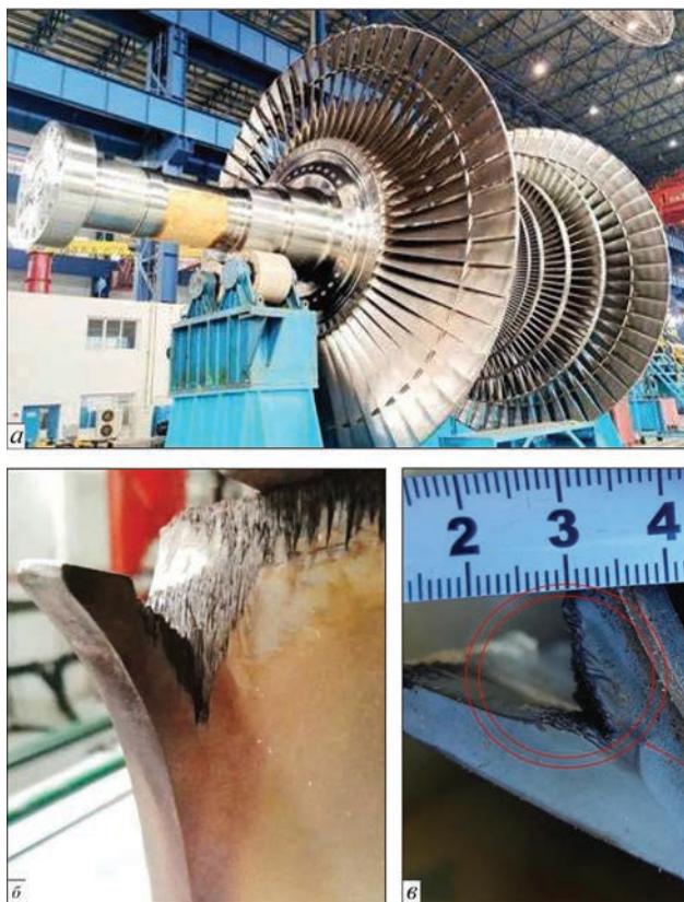
Рис. 1. Ротор парової турбіни (а), пошкодження лопатки від гідроерозії (б) та параметри зони, яка потребує відновлення лазерним наплавленням (в)
