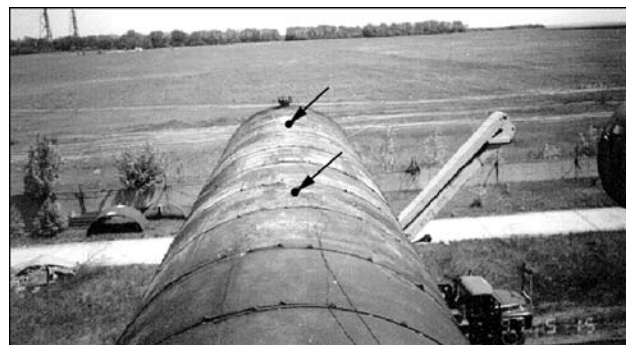
Рис. 2. АЭ контроль хранилища (стрелками показаны места установки датчиков на поверхности объекта)
