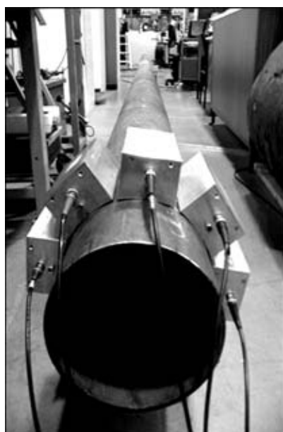
Рис. 13. Контроль труб УЗ волнами в ограниченных средах в продольном направлении. Выявление искусственного дефекта в виде пропила (50 % толщины стенки трубы) на расстоянии 10 м (а)
