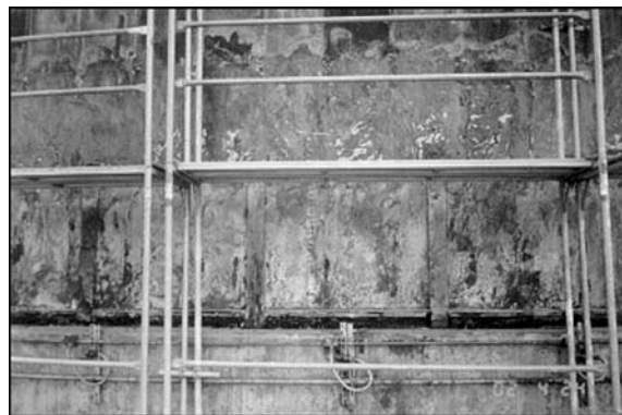
Рис. 4. Участок объекта контроля, подготовленный для определения коэффициента затухания УЗ колебаний
