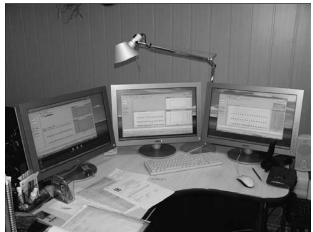
Информация, поступающая в формате XML в лабораторию НКТД Одесского припортового завода, преобразуется в графический формат (на экране — развертка объектов контроля с указанием координат сигналов АЭ)
