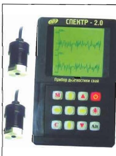
запуском одновременно по двум каналам и получать разложение каждого канала по 1000 линиям спектра;
