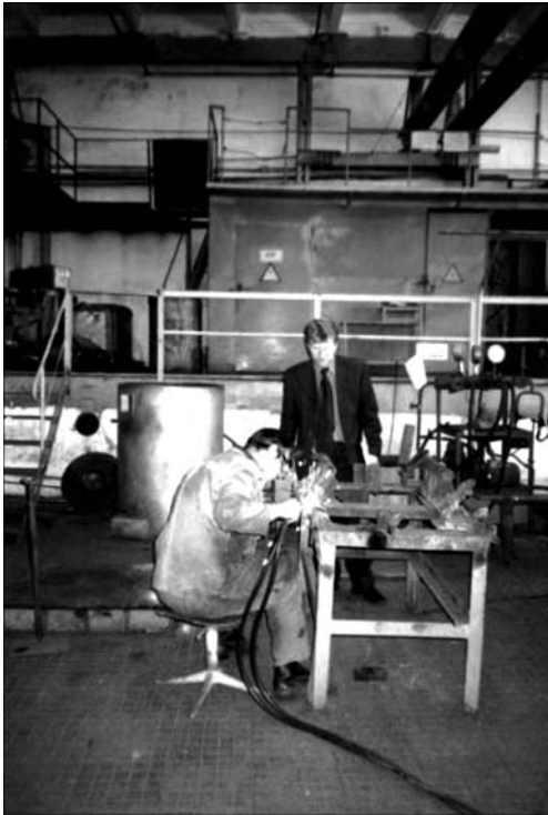
Рис. 9. Совместная с координатором сварочных работ подготовка образца сварного соединения для испытания технологического процесса по ДСТУ 3951.3–2001
