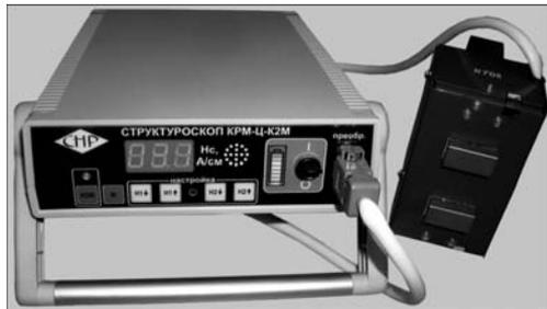
изделия превращает диагностику усталости в документируемую строгую и ответственную процедуру, лишенную даже оттенка субъективизма. Контроль может быть реализован как в ручном виде, так и в варианте стационарных систем (например, для кожуха доменной печи).
