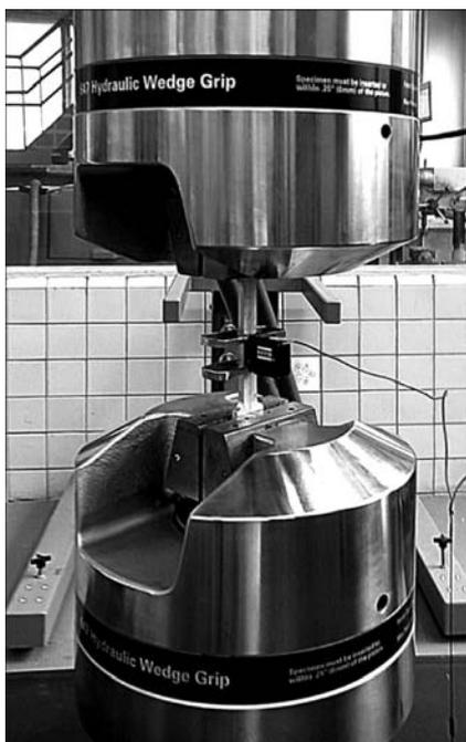
Рис. 1. Сервогидравлическая испытательная система MTS 318.25
