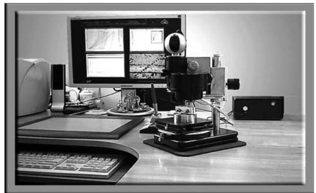
Рис. 4. Компьютеризированная микрозондовая система «Микрон-Гамма» для микромеханических испытаний при нагрузках от 5 до 500 г
