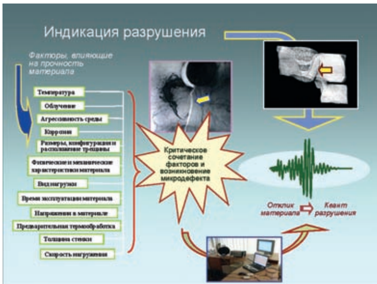
Рис. 2. Факторы, влияющие на возникновение и развитие разрушения, и квант АЭ как отклик материала на свое состояние
