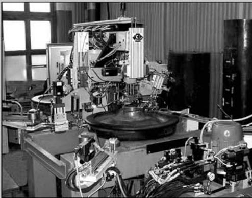
ОКБ ИЭС им. Е.О. Патона разработаны установки автоматического ультразвукового контроля (АУЗК) НК360-362 для неразрушающего контроля сварных швов и концевых участков труб диаметром от 508 до 1420 мм и толщиной стенки от 7 до 50 мм. Партию из шести таких установок ОКБ ИЭС поставило заводу в 2004–2005 гг. Они прошли зарубежную инспекцию по нормам DNVI, разрешившей участие ОАО «ВМЗ» в тендере на поставку труб для нефтепровода «Nord stream», в том числе по дну Балтийского моря.
