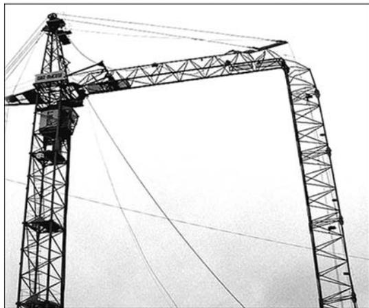
Если причина этих и подобных разрушений — усталость металла — их легко предотвратить, используя коэрцитиметрию при эксплуатационном контроле текущего состояния
