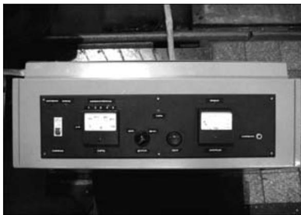
Рис. 8. Лицевая панель блока управления
