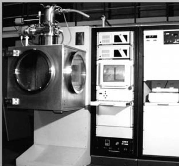
Установка СВ-112 комплектуется стационарной пушкой мощностью до 15 кВт, двухкоординатным столом (X-X' и Y-Y', перемещение 200 мм), универсальным вращателем и задней бабкой
