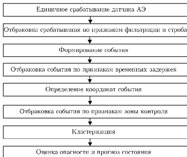
Рис. 7. Обработка АЭ информации в системе ЕМА-3
