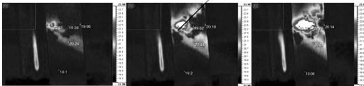
Рис. 4. Пример обнаружения дефекта (концентрактора напряжения) в металлическом образце мостового крана при циклическом механическом воздействии
