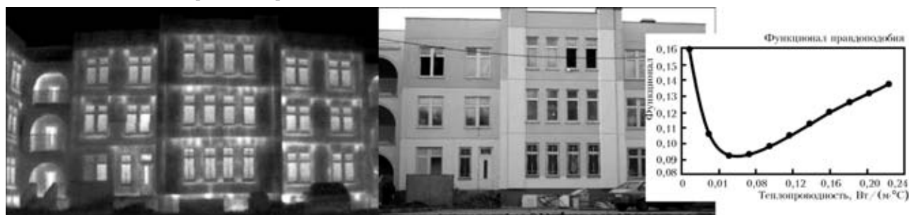
Рис. 2. Термограмма, фотография и результаты контроля здания
