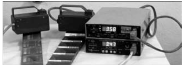
Рис. 10. Сравнительные замеры H_c на образцах различными структуроскопами
