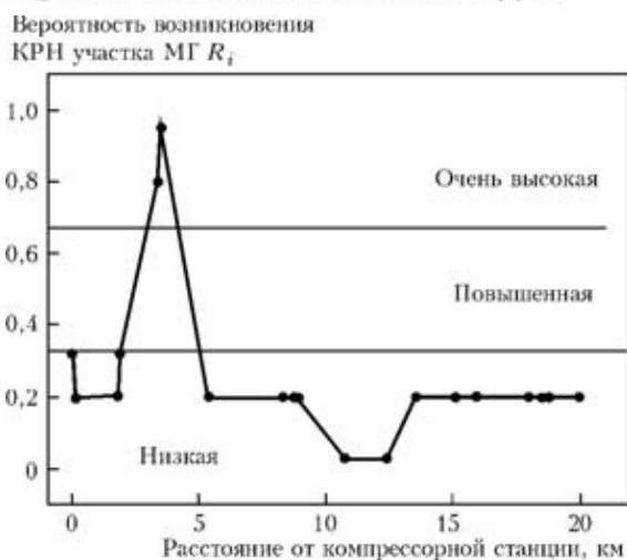
Рис. 2. Вероятность стресс-коррозионной опасности участка МГ «Уренгой–Помары–Ужгород» на разном расстоянии от КС, рассчитанная по данным проектной, исполнительной и эксплуатационной документации
