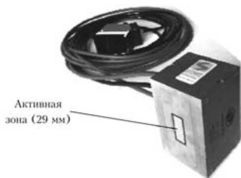
Рис. 7. УЗ преобразователь ФАР системы FFAST II
