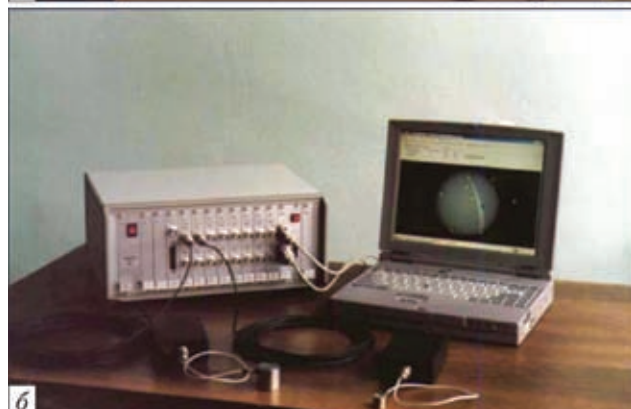
Рис. 5. 16-канальные мобильные системы АЭ контроля ЕМА-3 (а) и СДАЭ-16 (б)
