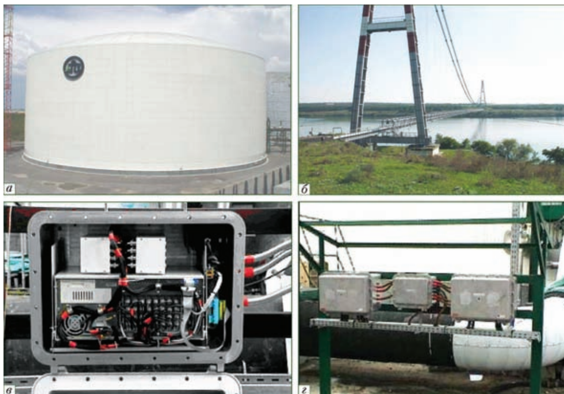
Рис. 3. Системы непрерывного АЭ мониторинга хранилищ жидкого аммиака и мостовой переход аммиакопровода через р. Днепр: а — хранилище аммиака ОПЗ; б — аммиакопровод на мосту через р. Днепр; в — измерительный блок системы АЭ мониторинга в период монтажа; г — система АЭ мониторинга после герметизации в специальных взрывопожаробезопасных контейнерах с климатконтролем
