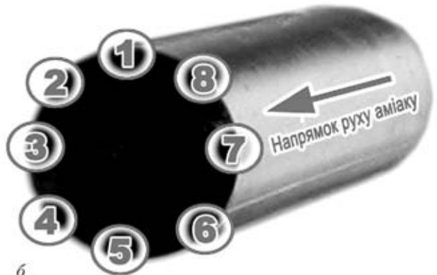
Рис. 1. Місце вимірювання (шурф) (а) і місця та порядок розташування точок перерізу 1–8, на яких проводили вимірювання (б)
