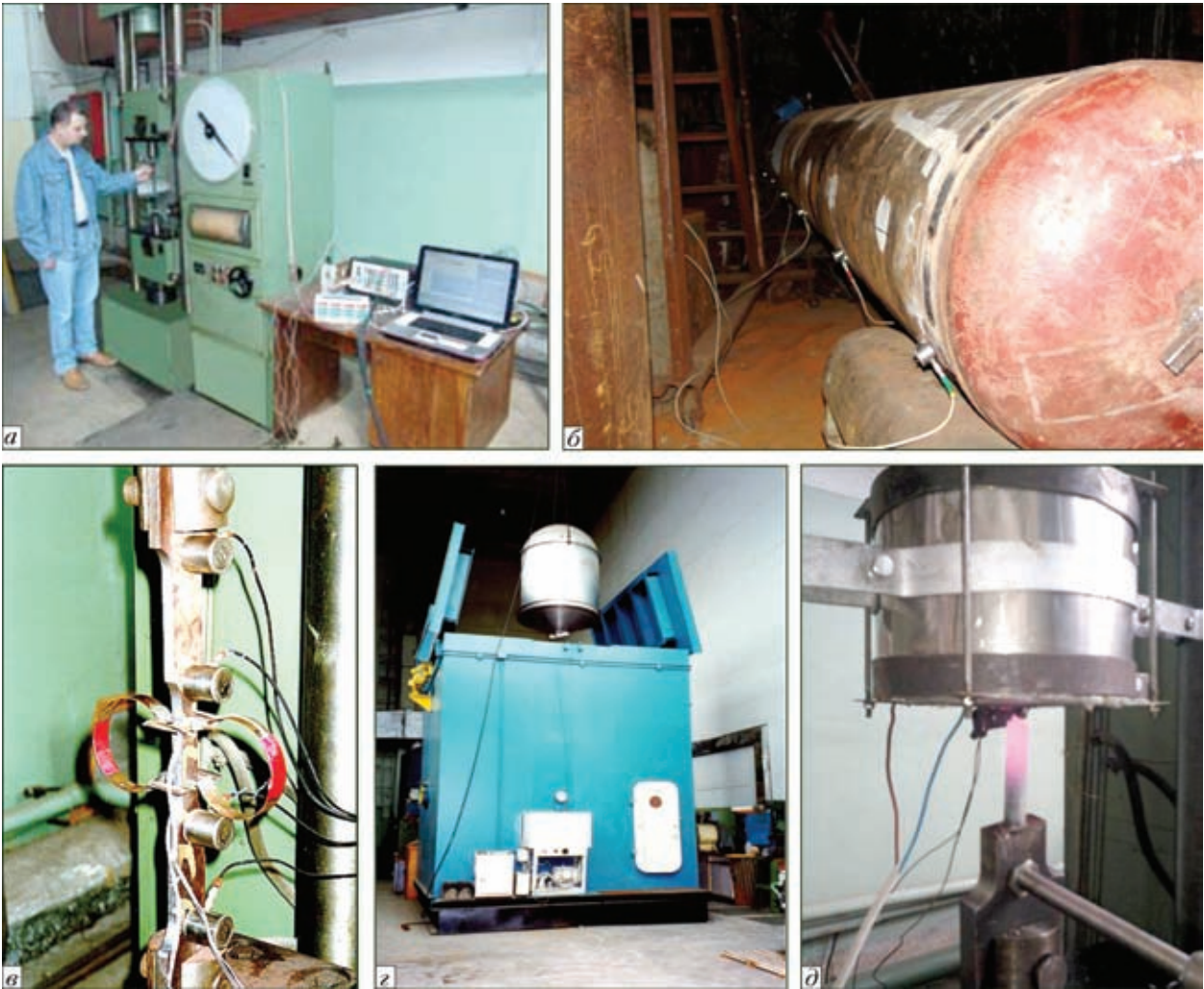
Рис. 2. Современный вариант системы ЕМА-3 перед проведением высокотемпературного испытания (а); датчики системы ЕМА-3 при гидроиспытаниях трубы (б); датчики АЭ на образце из трубной стали (в); специальный стенд ИЭС для АЭ испытаний конструкций (г); образец, нагретый до 820 °С при высокотемпературных АЭ испытаниях (д)
