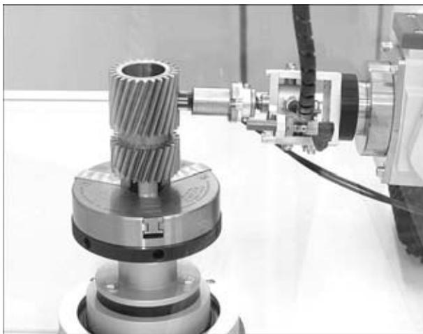
Рис. 7. Процесс контроля винтового зубчатого колеса
