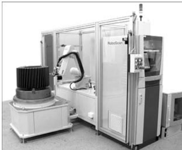
Рис. 5. Автоматизированная система контроля зубчатых колес
