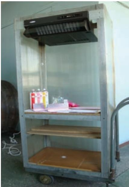
Передвижной стенд для капиллярного контроля с фильтрующей вытяжкой
