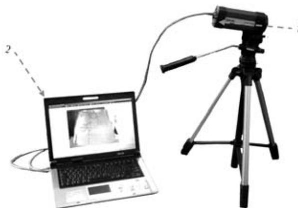
Рис. 5. Общий вид установки для теплового контроля: 1 — тепловизор; 2 — ЭВМ
