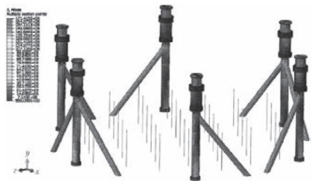
Рис. 6. Сейсмические напряжения в МК ВБ при учете двух распорок для МРЗ 7 баллов (0,1g) в зоне штанг М90 верхнего пояса и присоединения к надставке (максимальные сейсмические напряжения 171 МПа)
