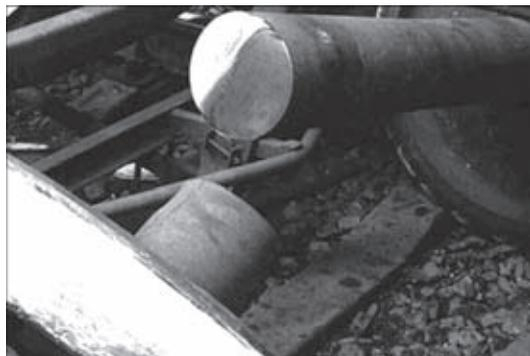
Рис. 1. Излом железнодорожной оси с внутренним дефектом
