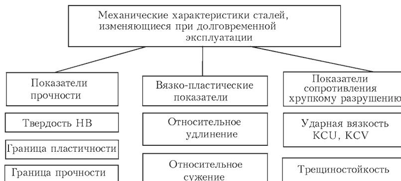
Рис. 3. Механические свойства сталей, изменяющиеся в процессе длительной эксплуатации трубопровода
