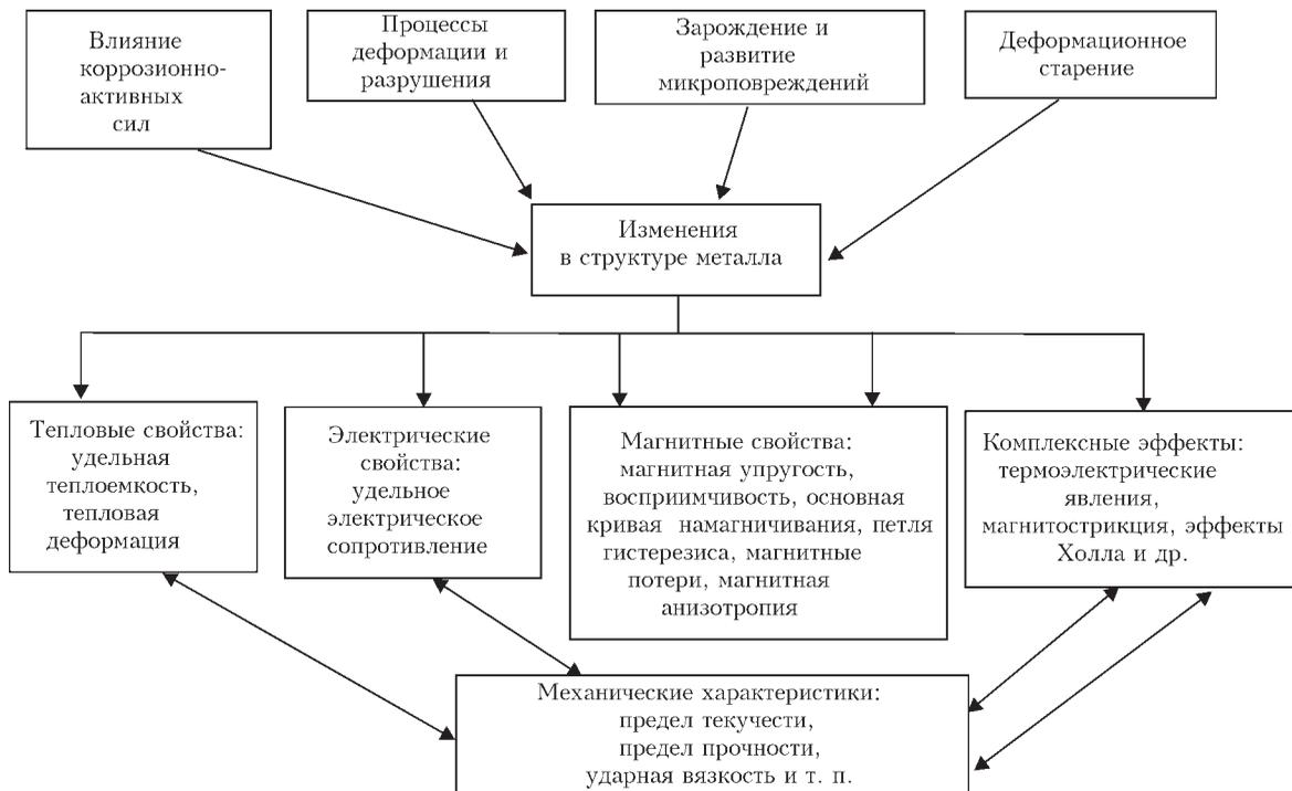
Рис. 4. Модель влияния внешних факторов на изменение физико-механических свойств
