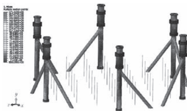
Рис. 6. Сейсмические напряжения в МК ВБ при учете двух распорок для МРЗ 7 баллов (0,1g) в зоне штанг М90 верхнего пояса и присоединения к надставке (максимальные сейсмические напряжения 171 МПа)
