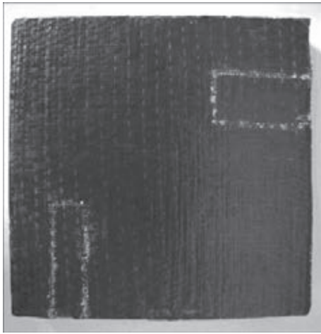
Рис. 3. Исследуемая пластина с обозначенными местами расположения дефектов
