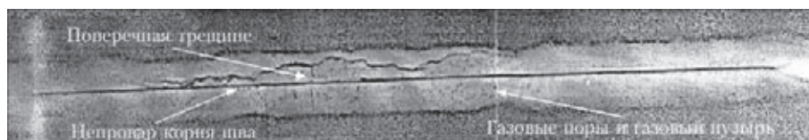
Рис. 5. Сварной шов: пористость, трещины и непровар
