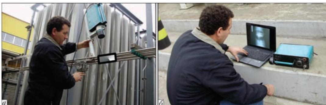
Рис. 9. Применение портативного цифрового рентгено-телевизионного оборудования: а – размещение аппаратуры на объекте; б – анализ результатов контроля на экране ноутбука
