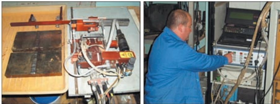
Рис. 23. Система P-scan
