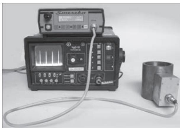
Рис. 4. Дефектоскопический комплект с ЭМА приставкой – контроль трубчатого образца
