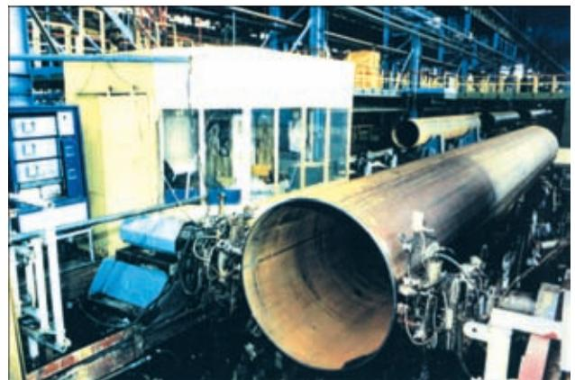
Рис. 21. Полный цикл контроля труб магистральных трубопроводов
