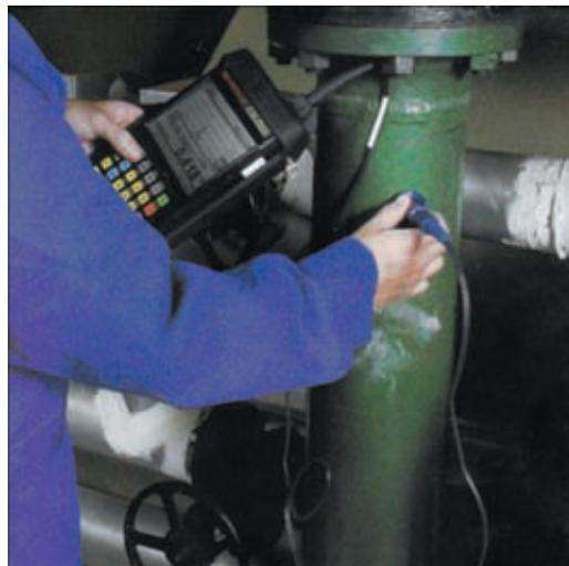
Рис. 6. Применение вихретоковых, феррозондовых, магнитометрических приборов
