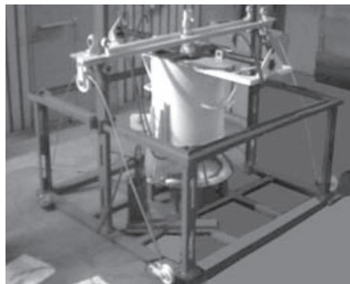
Рис. 20. Модуль для соединения разрушенных труб скважин
