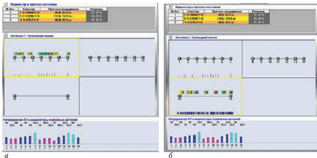
Рис. 4. АЭ активность трубопровода в рабочем состоянии через 1 ч от начала контроля при первоначальных настройках системы (а), без использования фильтров (б)
