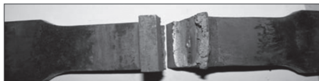
Рис. 5. Результаты усталостных испытаний сварных образцов стали 15ХСНД: а – после сварки (0) и после УЗУО (1–4) на воздухе (2) и в 3%-ном растворе NaCl (1,3,4) после УЗУО без ЭИЛ (2), ЭИЛ(Ni)+ УЗУО (3) и УЗУО+ЭИЛ(Cr)+УЗУО (4); б – образец после испытаний
