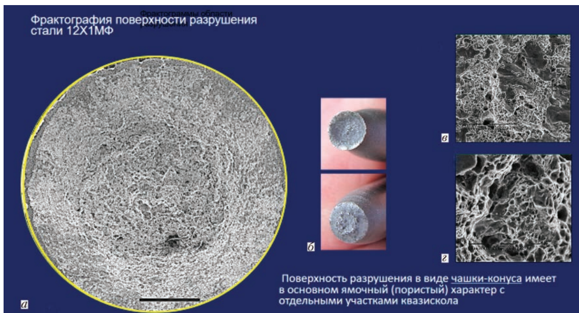
Рис. 4. Поры на поверхности разрушения: а – фрактография всей поверхности разрушения (×20,4); б – вид разрушенной части образца; в, г – многочисленные поры (черные точки и пятна) на поверхности разрушения (×600 и ×2010, соответственно)
