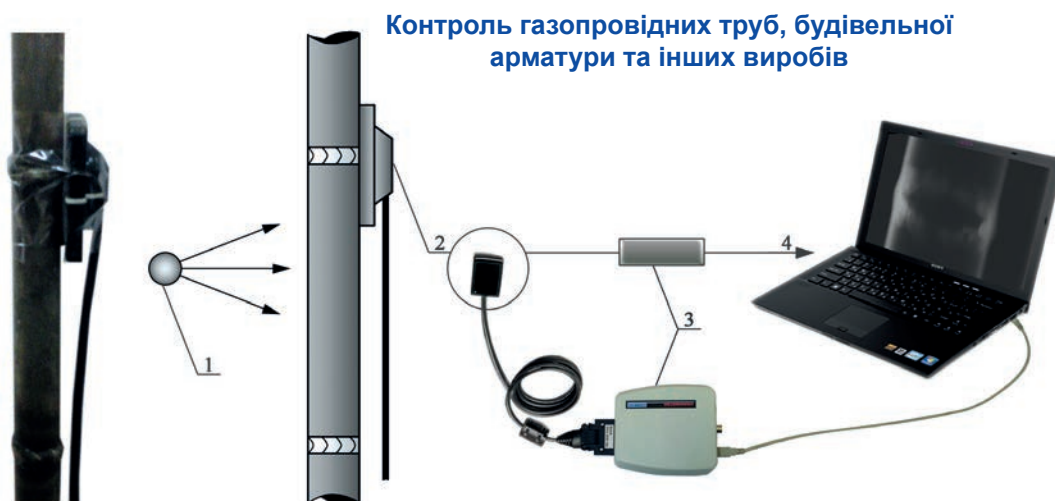
1 – джерело радіаційного випромінювання; 2 – мініатюрний твердотільний перетворювач; 3 – блок передачі цифрових зображень; 4 – передача зображень на екран монітора
