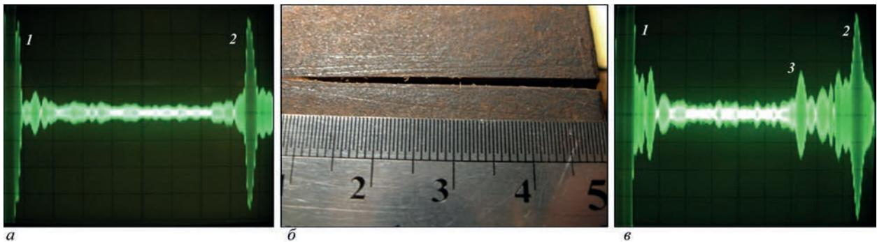
Рис. 2. Реализации для случаев бездефектного участка (а) листа из стали 09Г2С и при наличии поверхностного дефекта (в) в виде риски (б) размерами  $35 \times 1 \times 2,2$  мм (описание 1–3 см. в тексте)
