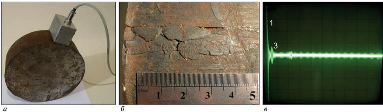
Рис. 6. Образец из заготовки круглого сечения (а), фото естественного дефекта (б) и реализация с эхо-импульсом от этого дефекта (в) (описание 1, 3 см. в тексте)
