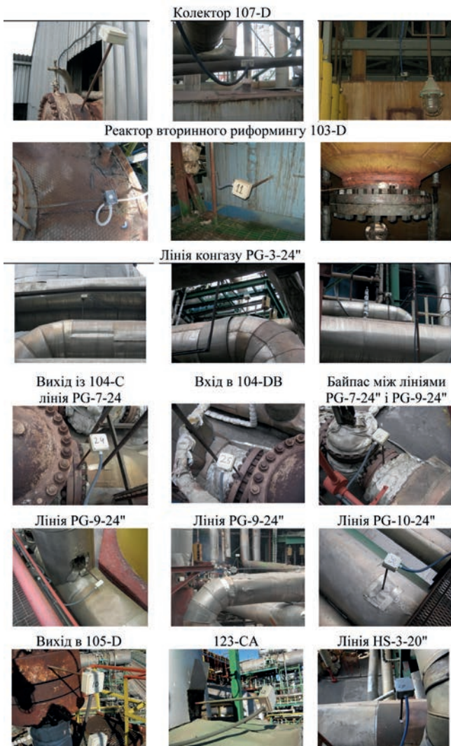
Рис. 8. Датчики АЕ, встановлені на об'єктах АЕ моніторингу ЦВирА
