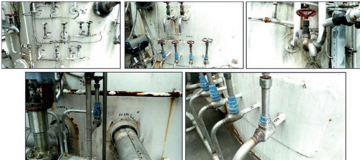
Рис. 11. Підготовка місць для встановлення датчиків АЕ (вибірково)
