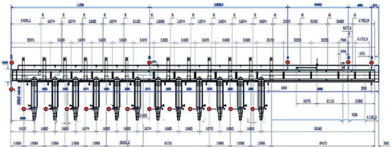
Рис. 6. Первинний риформінг (колектор 107-D та підйомні труби)
