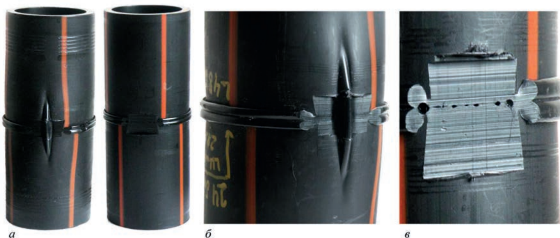
Рис. 1. Зразки поліетиленової труби (а), здуття труби після гідравлічних випробувань (б), пори в зварному шві (в)
