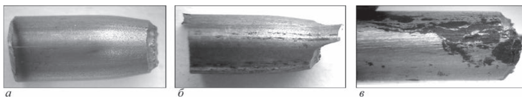
Рис. 8. Зовнішня поверхня дротів армоканату АК 49Ц після випробувань на короткочасне розтягування: а – на відстані 170 м від коушу; б – на відстані 40 м від коушу; в – з нижньої (щодо розриву) частини
