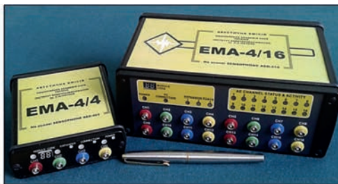
Рис. 6. Випробування елементів морських стаціонарних платформ акустико-емісійним методом
