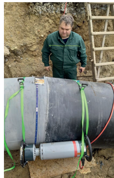
Рентгенографічний контроль трубопроводу, 2021 р.
