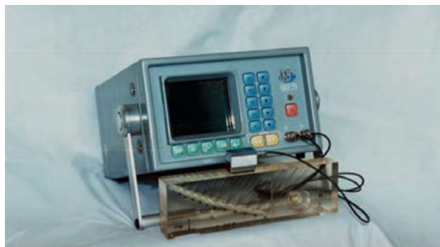
Перший вітчизняний ультразвуковий дефектоскоп УД2-70
