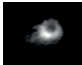
Виявлення глухого отвору на частоті 12,5 кГц
