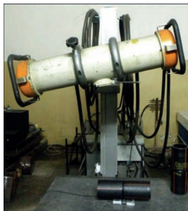
Рис. 3. Просвічування на рентген-апараті РАП 150/300
