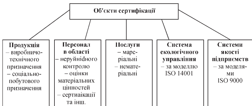
Рис. 2. Об'єкти сертифікації в зварюальному виробництві конструкцій [4]
