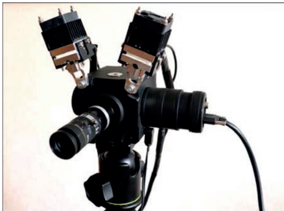
Рис. 2. Зовнішній вигляд широкографічного інтерферометра із лазерними модулями
