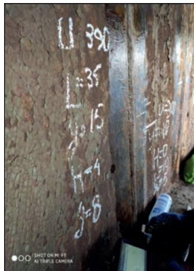
Рис. 3. Контроль стикових вертикальних швів з'єднувальної вставки
