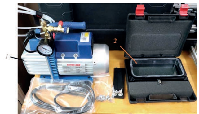
Рис. 4. Зовнішній вигляд вакуумної накладної камери (1) та компресора (2)
