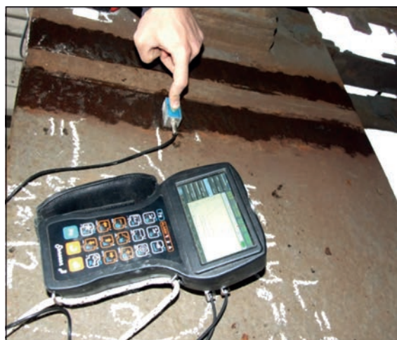
Рис. 4. Контроль стикового шва у верхньому поясі з'єднувальної вставки
