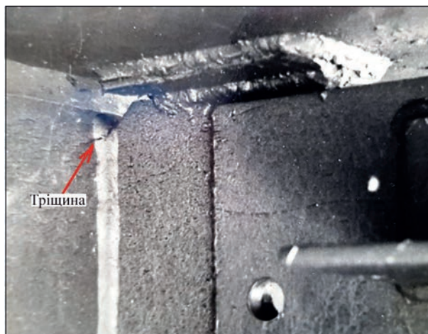
Рис. 5. Приклад дефекту, який було залишено при монтажі біля 12-ї опори (в подальшому кінці тріщини було засвердлено) [2]
