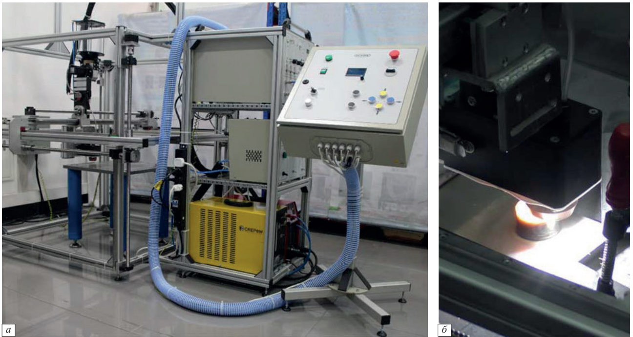
Рис. 10. Зовнішній вигляд установки (а) і процесу (б) мікроплазмового 3D-друку порошковими матеріалами
