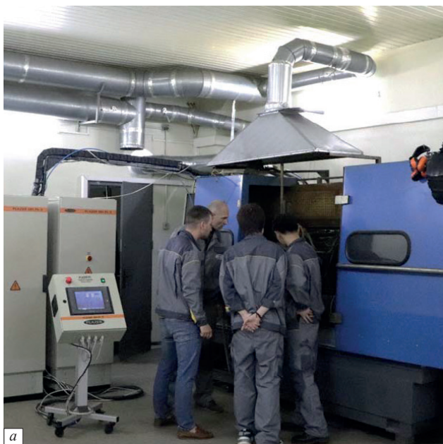
Рис. 11. Обладнання для реалізації плазмово-дугових технологій нанесення покриттів та обробки матеріалів: а – універсальний технологічний комплекс плазмово-дугового напилювання та різання; б – дослідна установка для плазмово-дугової сферодизації дротових матеріалів та прутків і порошоків неправильної форми
