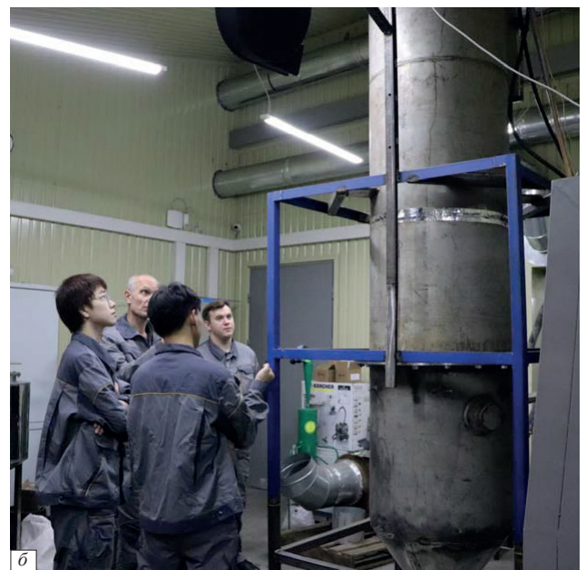
Рис. 11. Обладнання для реалізації плазмово-дугових технологій нанесення покриттів та обробки матеріалів: а – універсальний технологічний комплекс плазмово-дугового напилювання та різання; б – дослідна установка для плазмово-дугової сферодизації дротових матеріалів та прутків і порошоків неправильної форми
