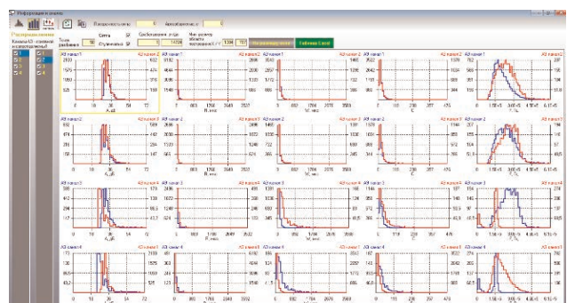
Рис. 3. Вікно аналізу даних з графіками розподілів даних АЕ по каналах у програмі ЕМА-3.92
