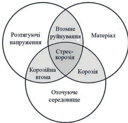
Рис. 3. Умовна схема впливу взаємодії різних факторів зовнішнього впливу на механізм руйнування конструкційних матеріалів
