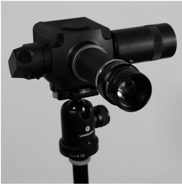
Рис. 2. Зовнішній вигляд широкографічного інтерферометра
